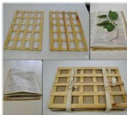
Figura 1. Processo de montagem da prensa para secagem
