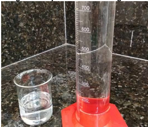
Fig. 4: Medição do volume de água
